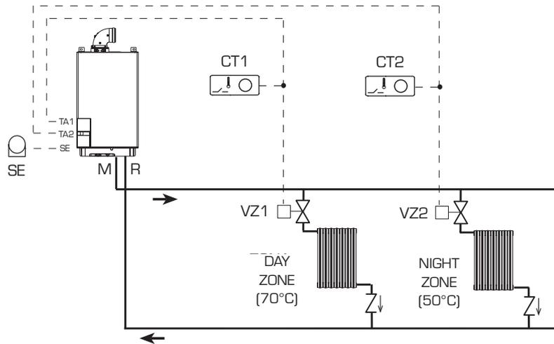
DURING NIGHT TIME THE BOILER USES A LOWER OUTPUT TEMPERATURE IF DIFFERENT TIMES HAVE BEEN SET FOR DAY AND NIGHT AREAS:
